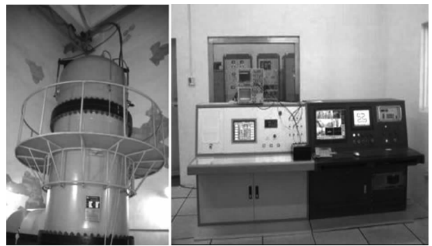
图3 电子加速器 图4 操作及束下监控平台
